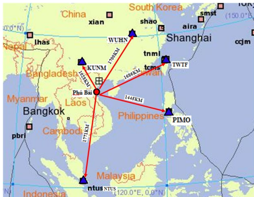
Hình 3 – Sơ đồ đo nối điểm PACS đến lưới IGS quốc tế
